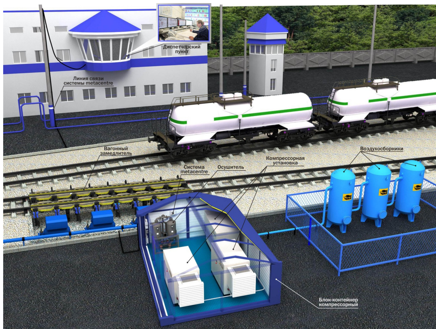
Рисунок 3. Схематическое изображение компрессорной станции (БКК)
